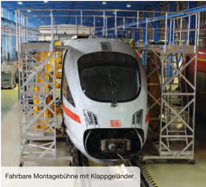
Laufboden mit Rammschutz und klappbarem Geländer
