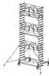
Arbeitshöhe: 7,50 m Standhöhe: 5,50 m Gerüsthöhe: 6,60 m
